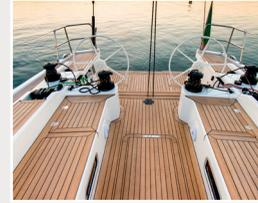
Il timone standard ha una pala dall'elevata efficienza profonda 2,50 metri. Il sistema di governo prevede due colonnine con circuiti separati e indipendenti più sicuri in mare.
