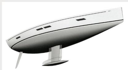
Differenti chiglie con diverso pescaggio. Oltre alle chiglie con differente immersione, è allo studio anche una deriva mobile basculante per fondali molto bassi.
