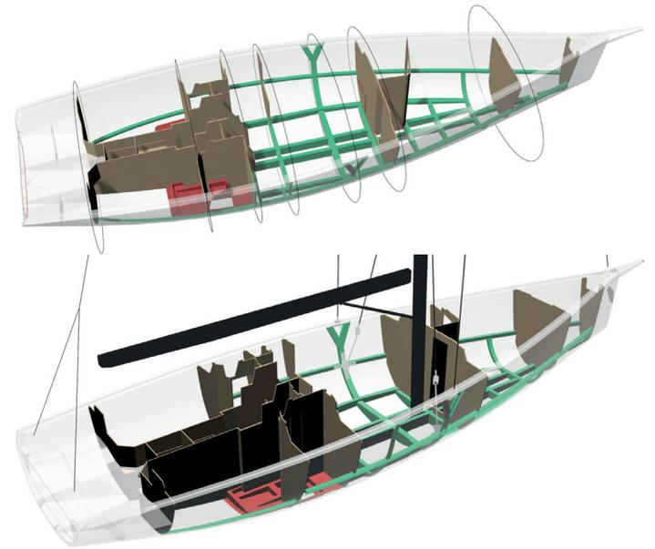
La struttura è basata su un ragno strutturale in carbonio, interamente fascettato a scafo per una elevata resistenza ai carichi. Le paratie sono in compensato marino, fazzolettate allo scafo, alla struttura interna e alla coperta.
